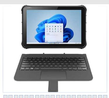
СуberBook T222J - защищенный планшет с 12,2-дюймовым экраном и клавиатурой\*, фактором защиты от влаги и пыли IP-65 и соответствием военным стандартам MIL-STD 810G . Планшет поддерживает ОС Windows 10/11, оснащен сенсорным IPS экраном, чувствительным к работе влажными руками и работе в перчатках, мощной литий-ионной батареей. Для удобства использования доступны аксессуары: dok-станция, чехол с клавиатурой, плечевой ремень, ручка для переноски, держатель для автомобиля, дополнительная батарея.
